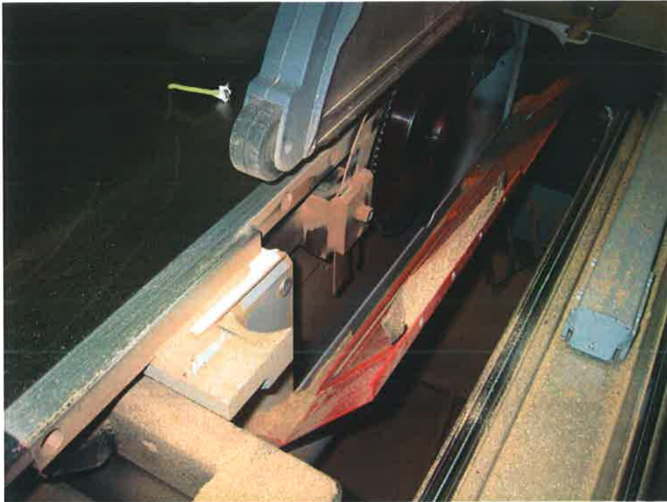
Rys. 2.6. Widok koleby dolnej z uchyloną osłoną boczną, [opracowanie własne].
