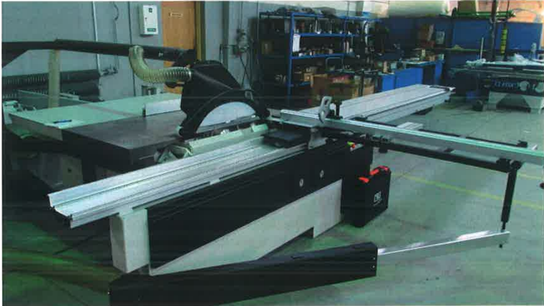
Rys. 3.1. Widok układu odpylania pilarki od strony stołu ruchomego, [opracowanie własne].
