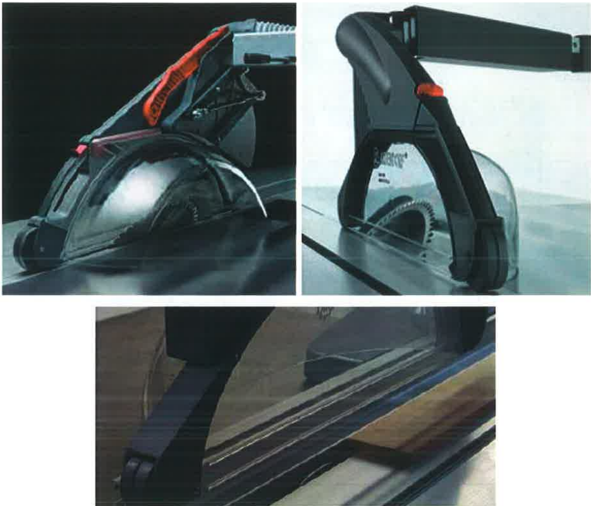
Rys. 2.3. Widok osłony w górnym układzie odpylania od strony nieruchomego stołu – widoczne są żebra usztywniające ściany boczne obudowy, [2].
