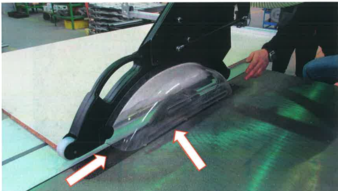
Rys. 3.2. Widok układu odpylania pilarki od strony osłony (założona szeroka osłona) do przecinania profilowego, [opracowanie własne].
