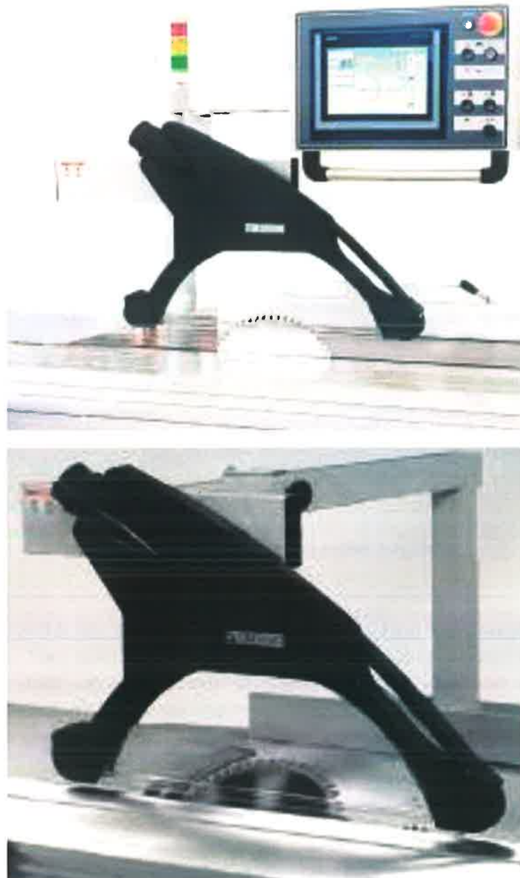
Rys. 2.10. Widok osłony górnej w układzie odpylania, [3].
