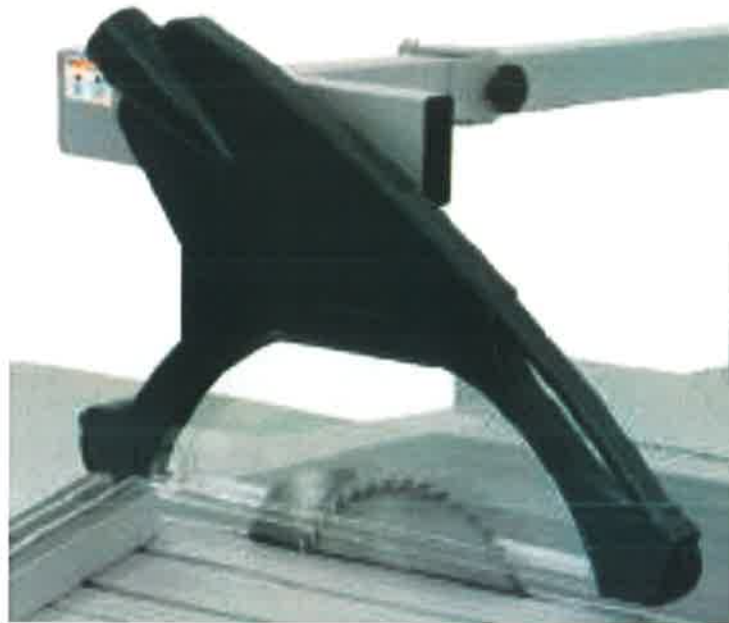
Rys. 2.14. Widok osłony w górnym układzie odpylania od strony stołu ruchomego, [4].
