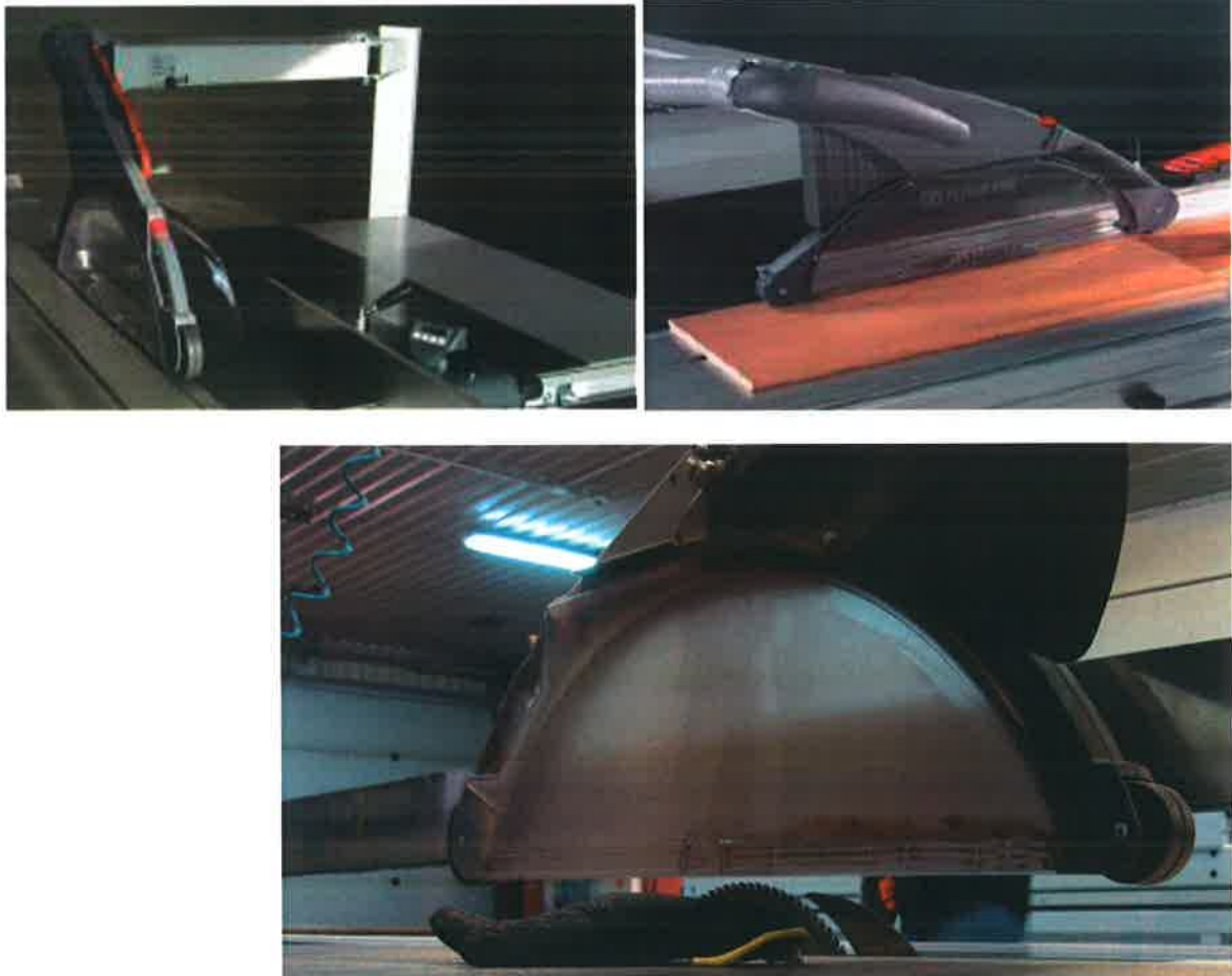
Rys. 2.2. Widok osłony górnego układu odpylania od strony stołu ruchomego – widoczne są żebra usztywniające ściankę boczną osłony, [opracowanie własne].
