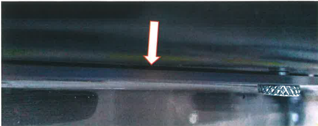
Rys. 3.7. Mocowanie osłony z obudową – brak szczelności na „linii kontaktu” , [opracowanie własne].
