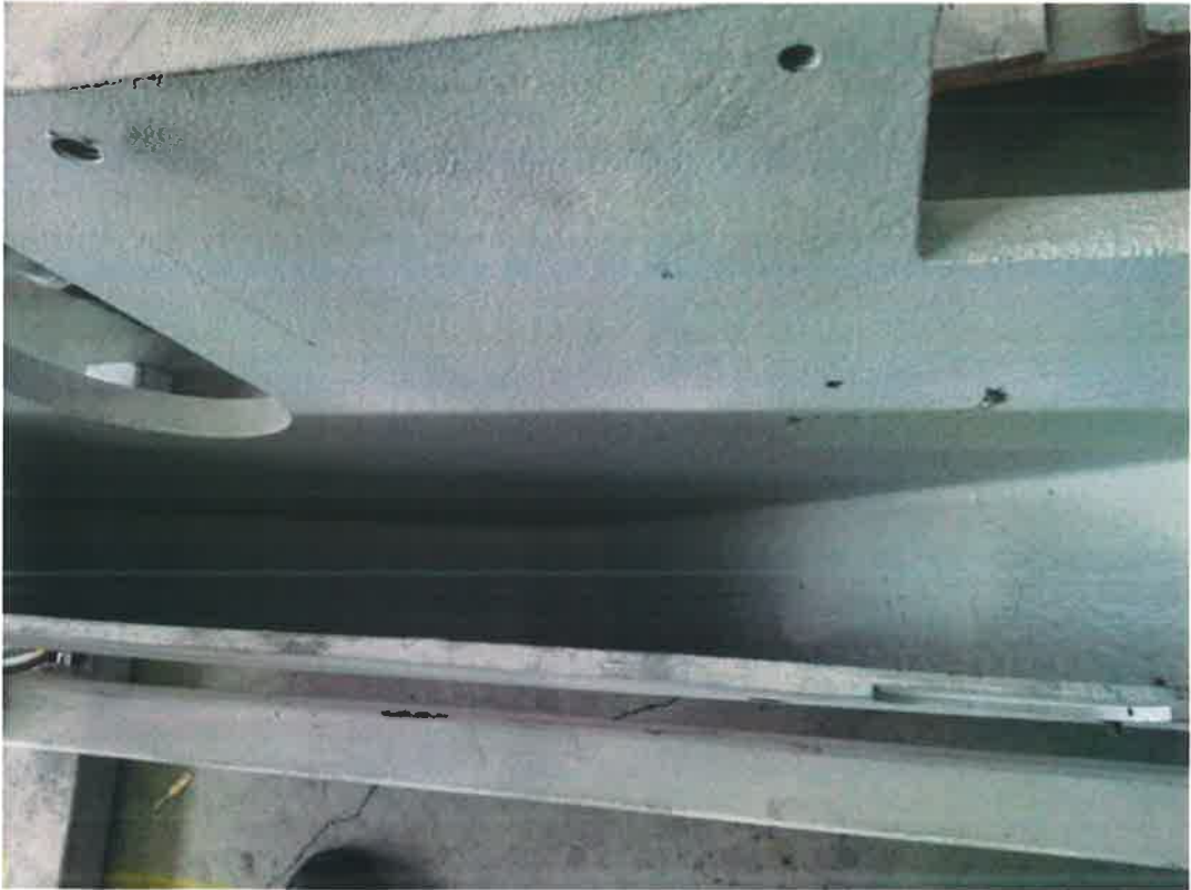
Rys. 1.7. Widok przedniej części koleby dolnej - widoczna chropowatość powierzchni i załamania ścianki dolnej, [opracowanie własne].
