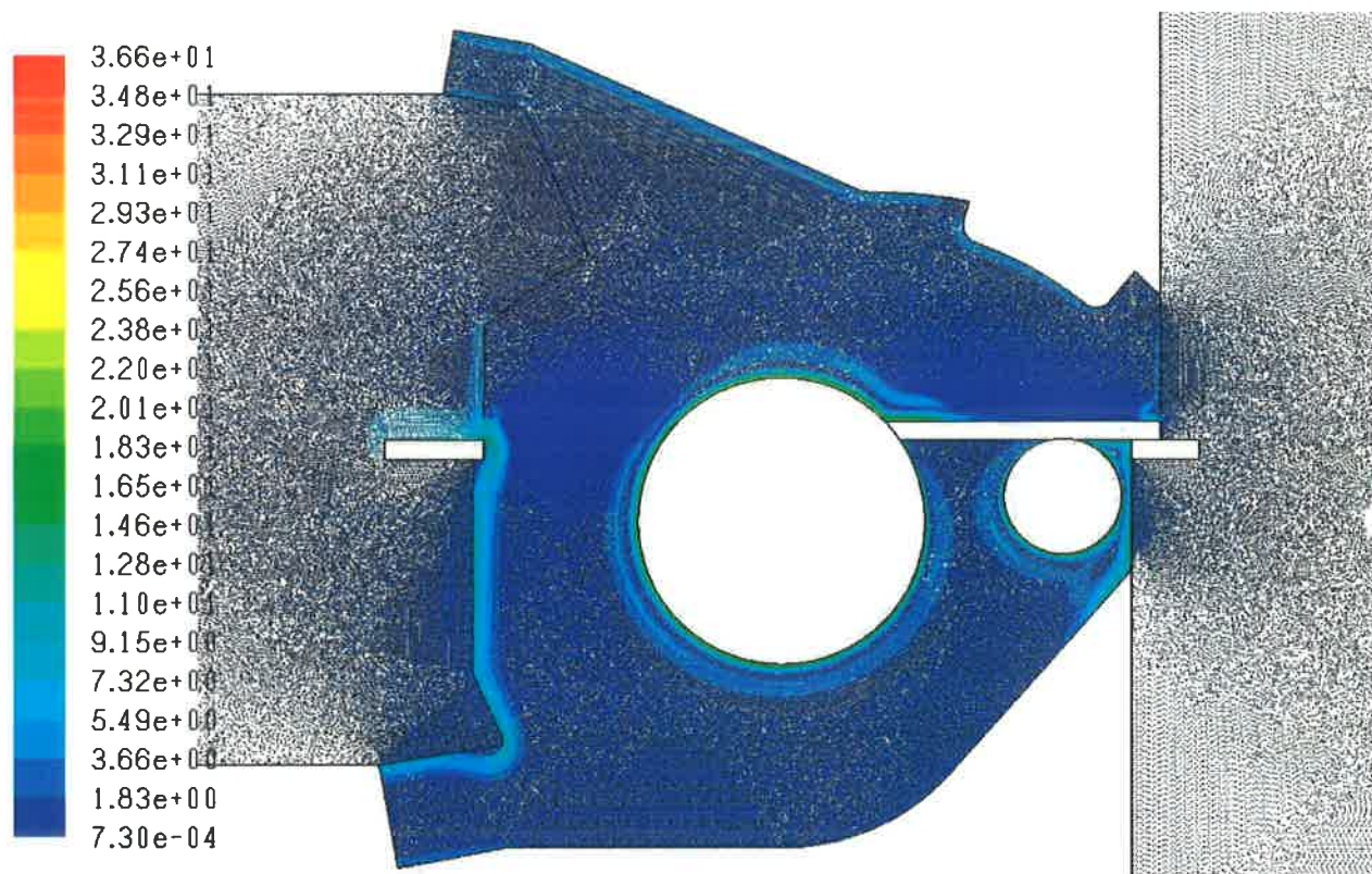
Rys. 3.1. Pole wektorów prędkości przepływu powietrza przez układ odpylania pilarki z piłą \varnothing 300 mm przy pracy bez noża rozdzielającego i z przecinanym materiałem (opracowanie własne)
