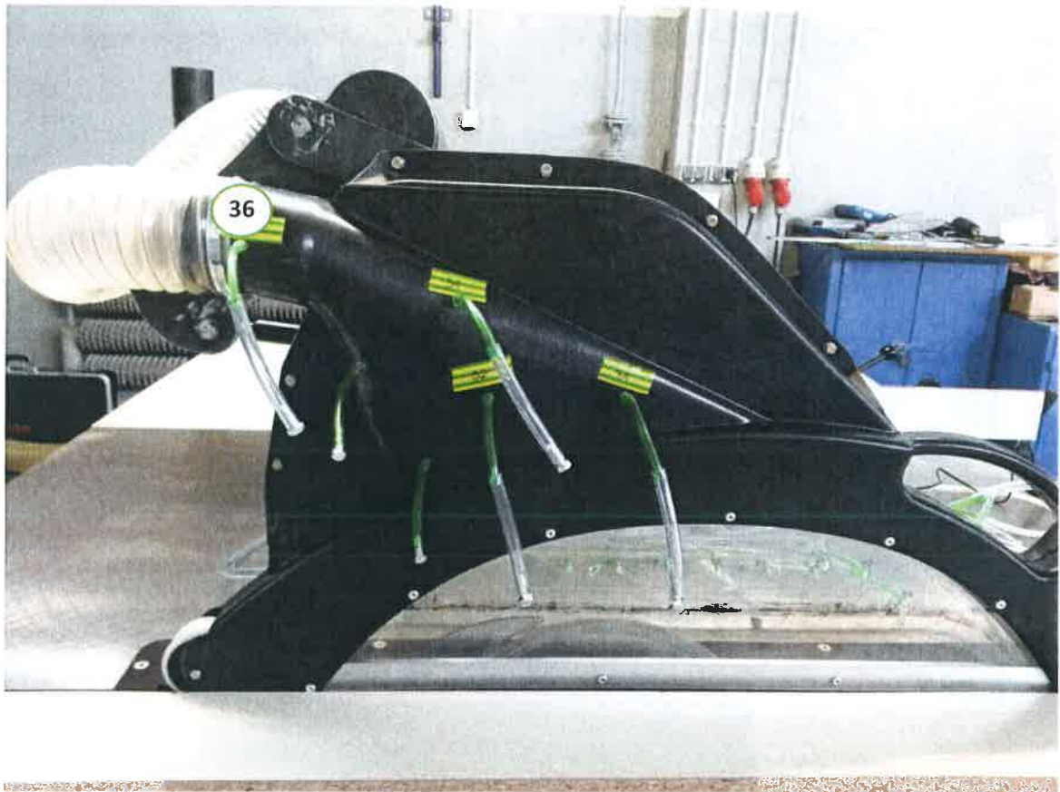
Rys. 2.3. Położenie punktu pomiarowego w króćcu wylotowym na górnej obudowie - pierwotna konstrukcja obudowy górnej, [opracowanie własne].
