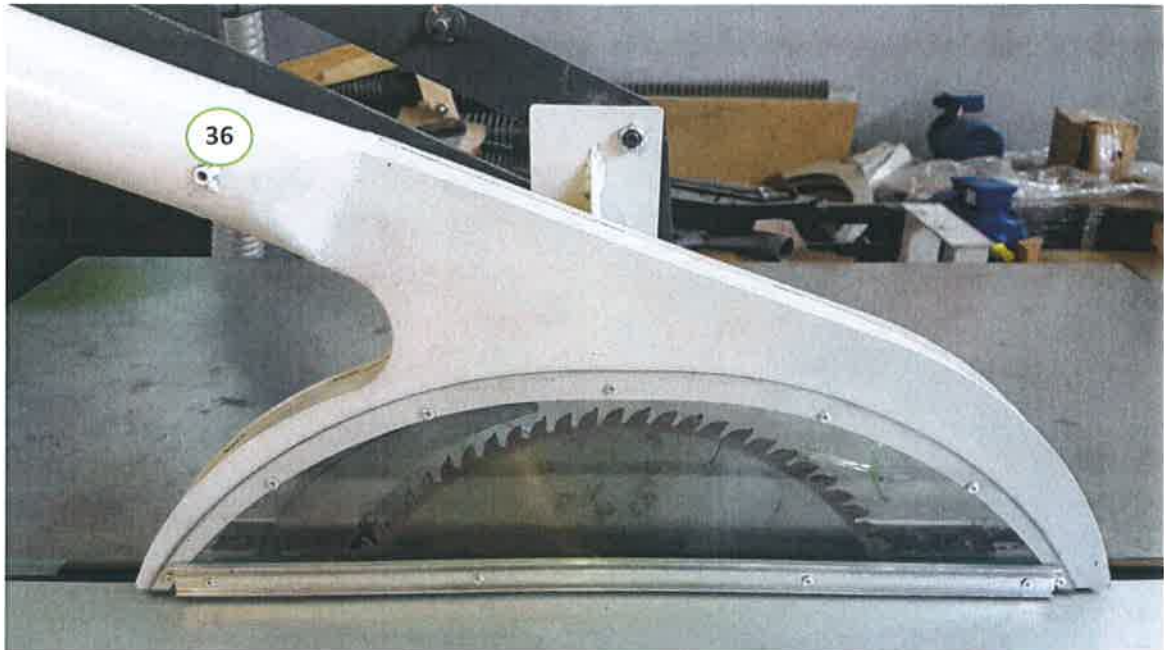
Rys. 2.5. Widok Prototypu VI obudowy górnej wraz z wskazanym punktem pomiarowym na króćcu wylotowym, [opracowanie własne].
