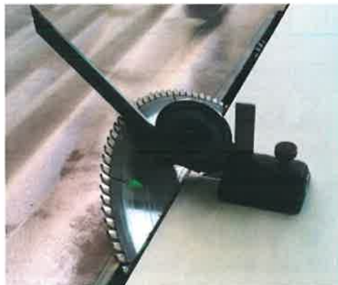
Rys.1.5-3. Ustawienie piły do kąta 45°.
