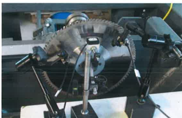
Rys.1.2.2. Rozlokowanie bezstykowych przetworników na pilarcie Fx550.
