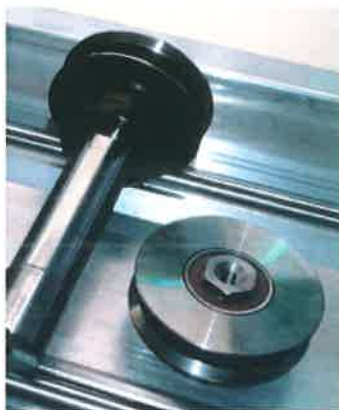
Rys.1.12-1. Rolka układu jezdnego stołu ruchomego.
