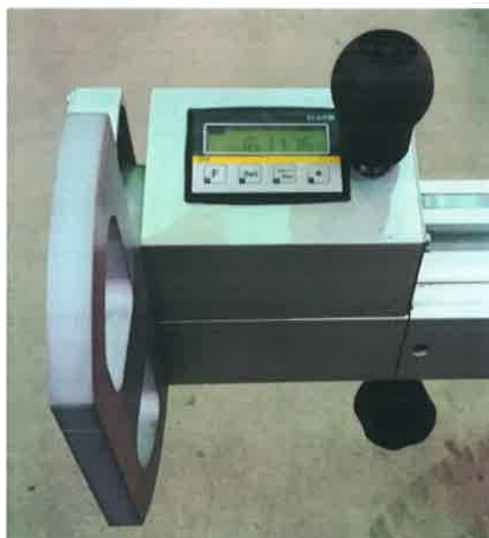
Rys.1.13-1. Zderzak na liniale poprzecznym.
