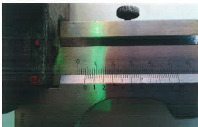
Rys.1.6 – 3. Odczyt wysokości piły podcinającej.
