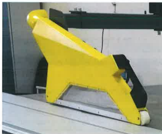
Rys.1.11-1. Osłona górna chroniąca dostęp do części wirujących, które znajdują się nad stołem.
