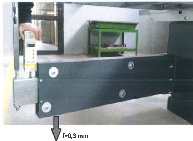
Rys.7. Obciążenie wspornika wychylnego siłą 500 N.
