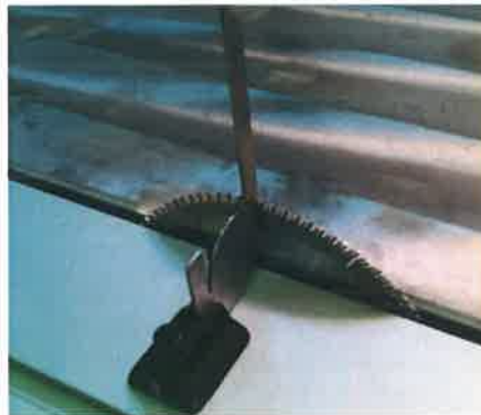
Rys.1.5-1. Ustawienie piły do kąta 0°.
