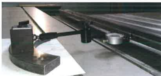
Rys.1.16-3. Badanie prostoliniowego toru jazdy stołu.
