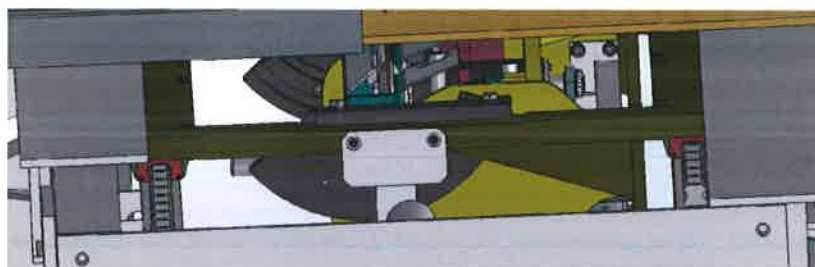
Rys.2. Widok poziomego toru jazdy na prowadnicach kształtowych.
