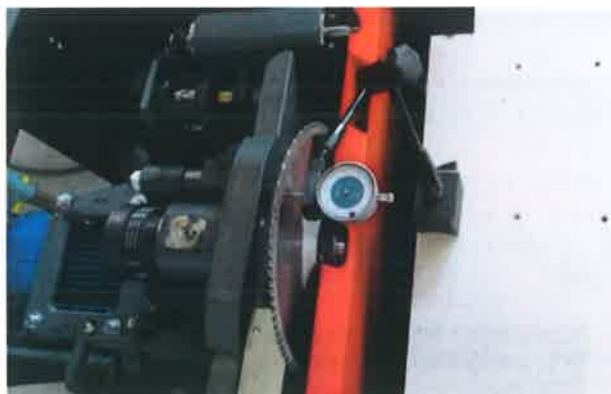
Rys. 1.14-1. Pomiar drgań wrzeciona głównego.
