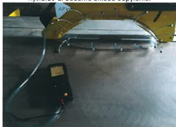
Rys.1.10-3. Pomiar ciśnienia na osłonie rzeczywistej.
