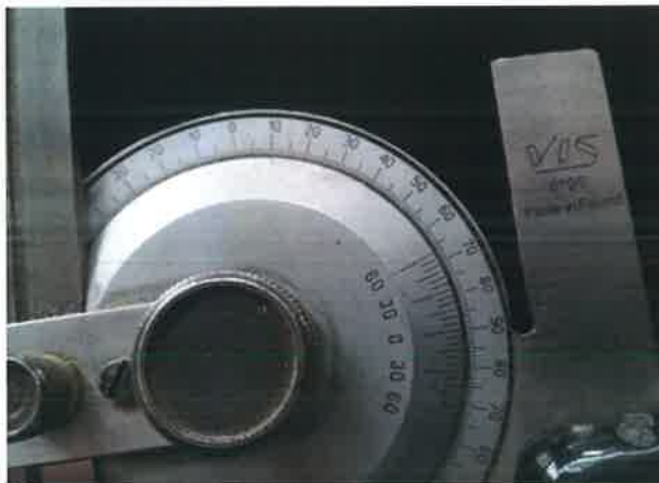
Rys.1.8-2. Odczyt kąta prostego z kątomierza.
