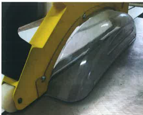
Rys.6. Osłona górna pilarki formatowej z zastosowaniem szerokiej zastłony z tworzywa sztucznego.
