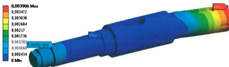
Rys.1.1.3. Odkształcenia wypadkowe [mm] nowego wrzeciona pilarki Fx550.
