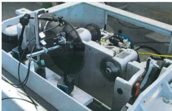
Rys.1.2.1. Rozlokowanie bezstykowych przetworników na pilarcie Fx3.
