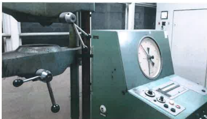
Rys.5. Maszyna zrywająca ZD20.
