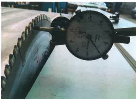
Rys.1.5-5. Ustawienie czujnika zegarowego przy kącie prostym.
