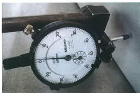
Rys.1.2-3. Widok czujnika po wróceniu liniału wzdłużnego z pozycji 1200 mm na 700 mm.
