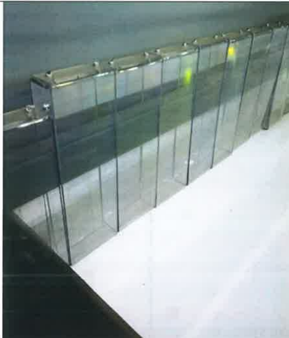
Rys.4. Zastłonki pilarki pośredniej wykonane z tworzywa sztucznego.
