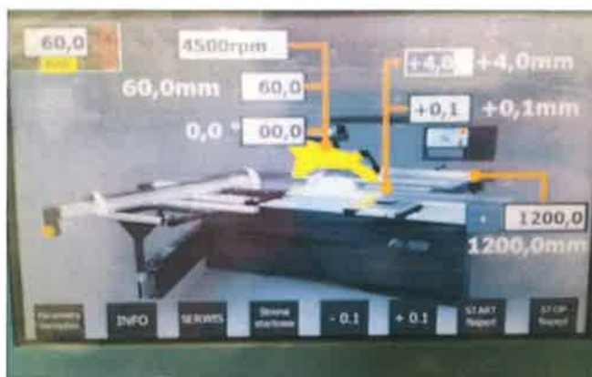
Rys.1.6 – 1. Pulpit sterowniczy. Ustawienie piły podcinającej na pozycję 4 mm.
