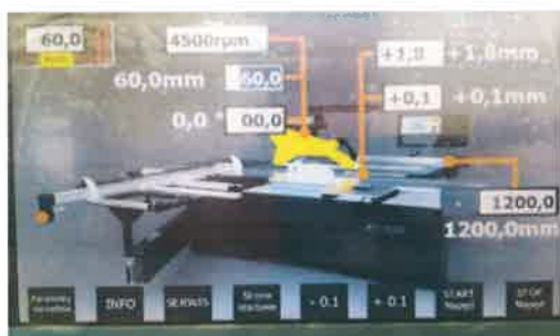
Rys.1.3-1. Pulpit sterowniczy. Wysokość piły ustawiona na 60 mm.
