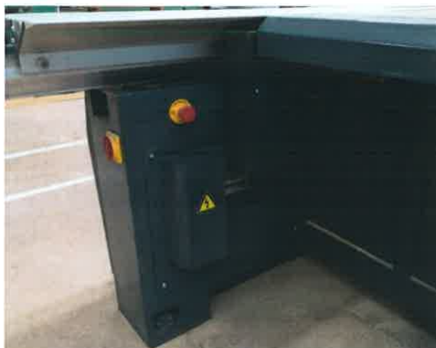
Rys.4. Widok skrzynki elektrycznej w pilarkie formatowej 3 osiowej.
