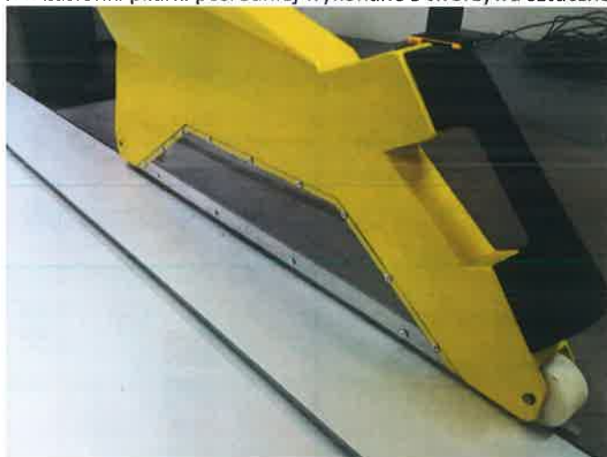
Rys.5. Osłona górna pilarki formatowej z zastosowaniem wąskiej zastłony z tworzywa sztucznego.
