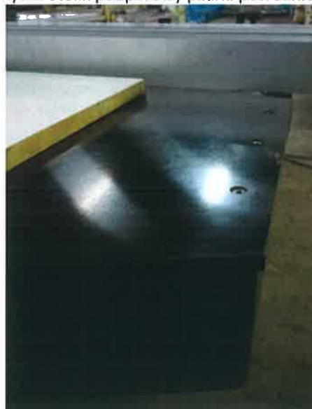
Rys.3. Stolik podporowy z liniałem poprzecznym pilarki pośredniej.
