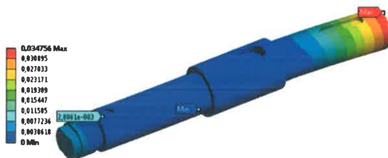
Rys.1.1.2. Odkształcenia wypadkowe [mm] wrzeciona pilarki Fx3.
