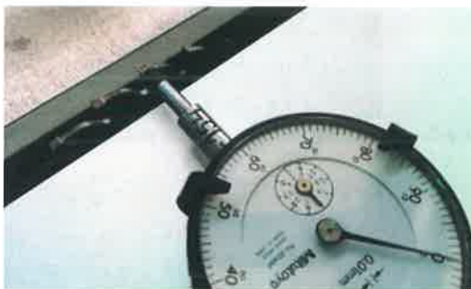
Rys.1.7-2. Ustawienie czujnika zegarowego.
