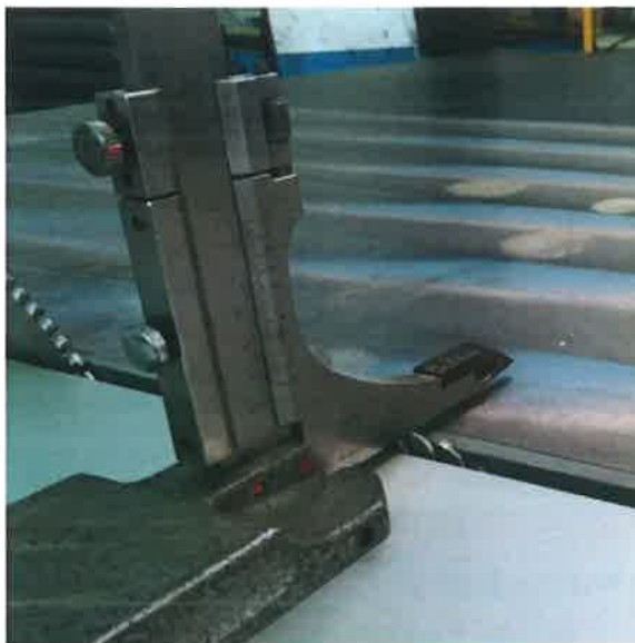
Rys.1.6 – 2. Pomiar wysokości piły podcinającej wysokościomierzem.
