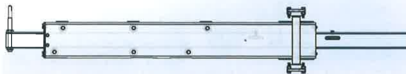
Rys.4. Wspornik wychylny montowany w Fx3 – II rodzaj. 6 rolek prowadzących kształtownik wewnętrzny.
